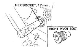
Tighten the left pivot bolt.
