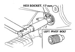
Install the pivot lock nut on the pivot bolt.
