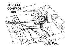
REVERSE CONTROL UNIT CONNECTOR OF THE WIRE HARNESS SIDE
